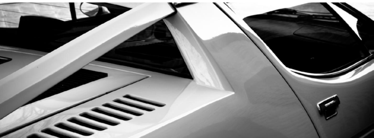
Una coppia di archi rampanti – la vera nota caratteristica della Merak – riprende la continuità lineare del modello ‘madre’, ricalcando il profilo dell’ampio vetro posteriore. Nella versione SS del 1975, la potenza del motore viene implementata fino a 220 CV e di conseguenza anche la velocità massima che su questa versione tocca i 240 km/h.
